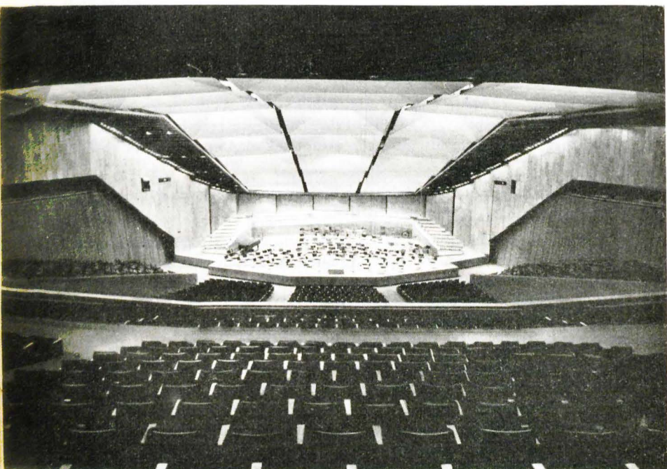
Abb. 8 Ansicht vom Saal auf die Bühne. Man sieht auch die schrägen, echoverhindernden Seitenwände.
