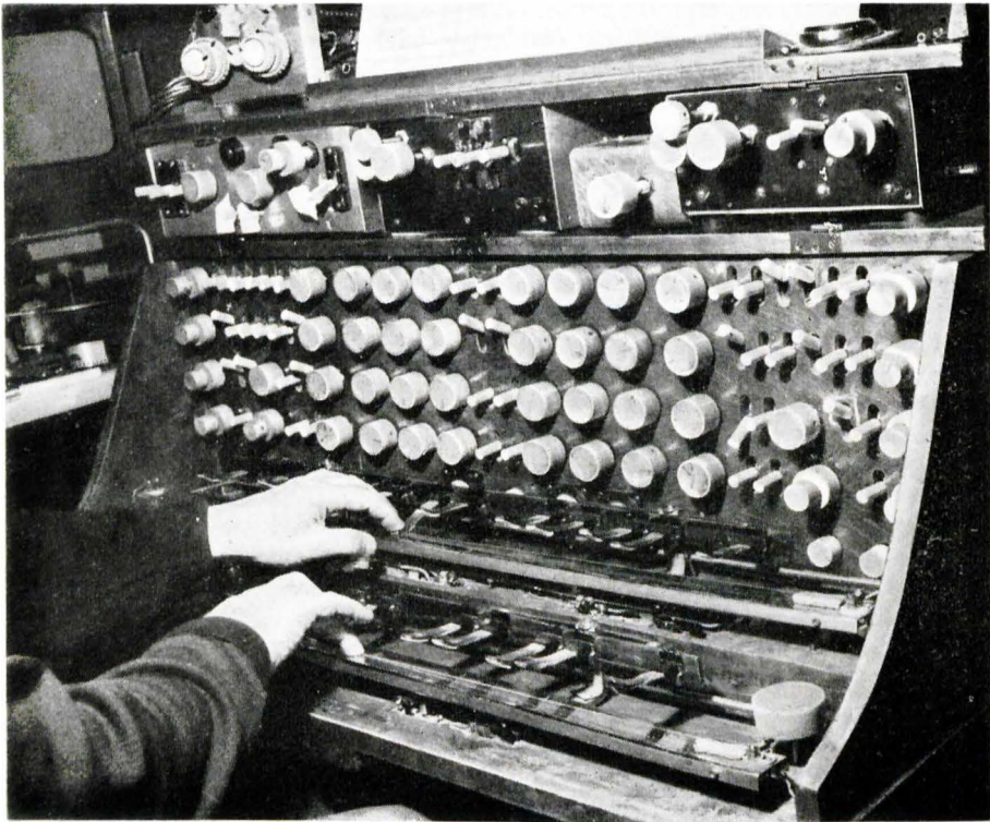
Abb. 1 Mixtur-Trautonium mit Saitenmanualen, Registern und elektronischem Schlagwerk.
