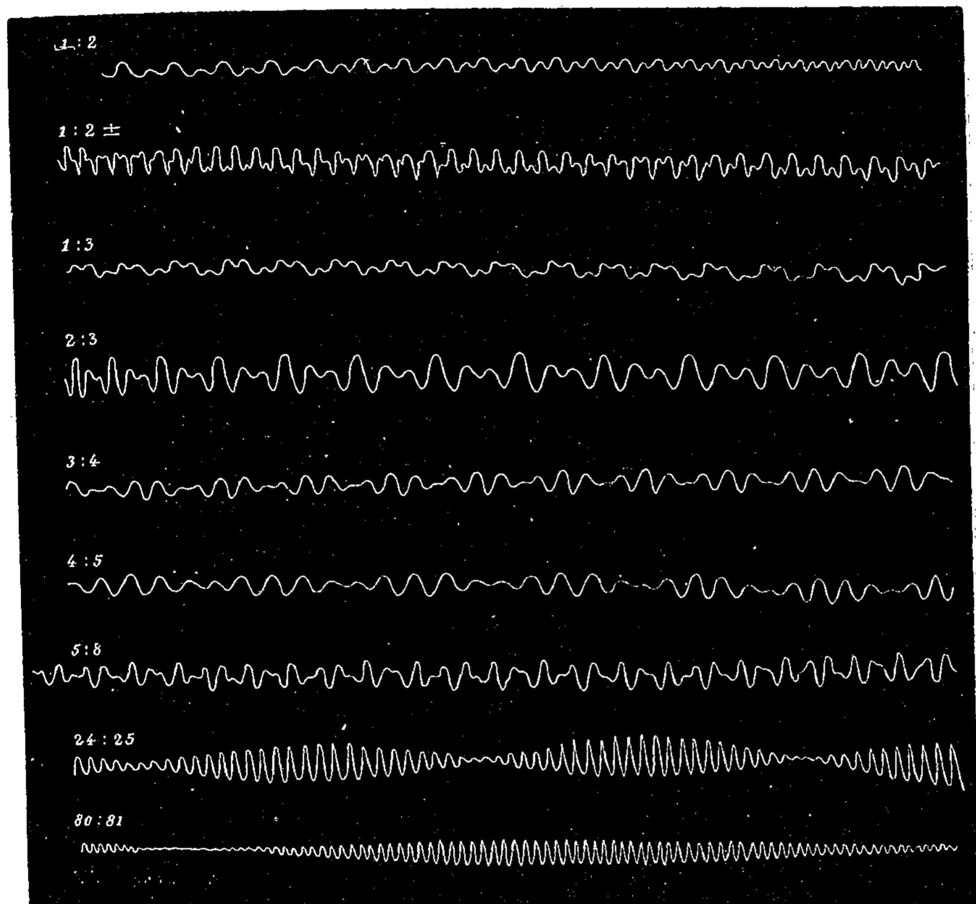
Fig. 4. Composition des mouvements vibratoires parallèles de deux diapasons.
