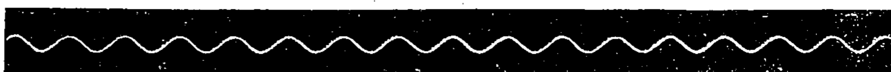
Fig. 3. Vibrations d'un diapason de 512 v. s., excitées par l'influence d'un diapason à l'unisson du premier.
