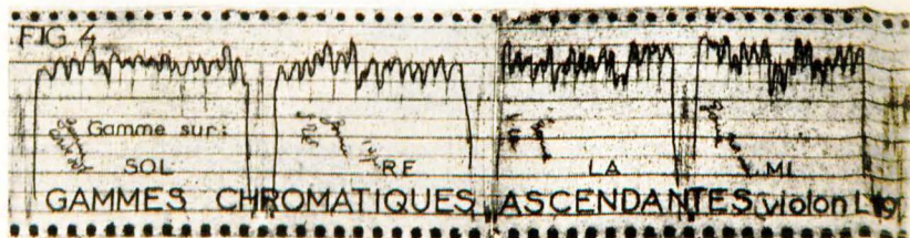
Fig. 4 Pegelstreifen von steigenden chromatischen Tonleitern im forte auf den vier Saiten einer modernen Geige Nr. L 19. Bemerkenswert ist die Ausgeglichenheit dieser Geige im Vergleich mit anderen Instrumenten wie die Savartsche trapezoidale Geige, die Schwankungen von mehr als 20 db aufweist.
