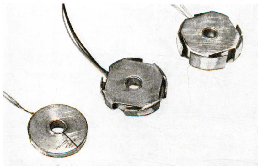
Fig. 5 Die verbesserte Kopfkonstruktion erlaubt Durchmesser bis zu 10 mm a. Bewickelter Mumetall-Spulenkörper b. Zusammengebauter Vierfachkopf für Halbspur: die Polbleche umschließen den Spulenkörper. c. Zusammengebauter Vierfachkopf für Vollspur
