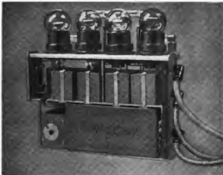
Abb. 185. Firma Dr. E. F. Huth: Empfänger Type E. L. mit Audion und Lautverstärker, eingebauter 25 Volt Anodenbatterie und Fernbedienung, geöffnet.
