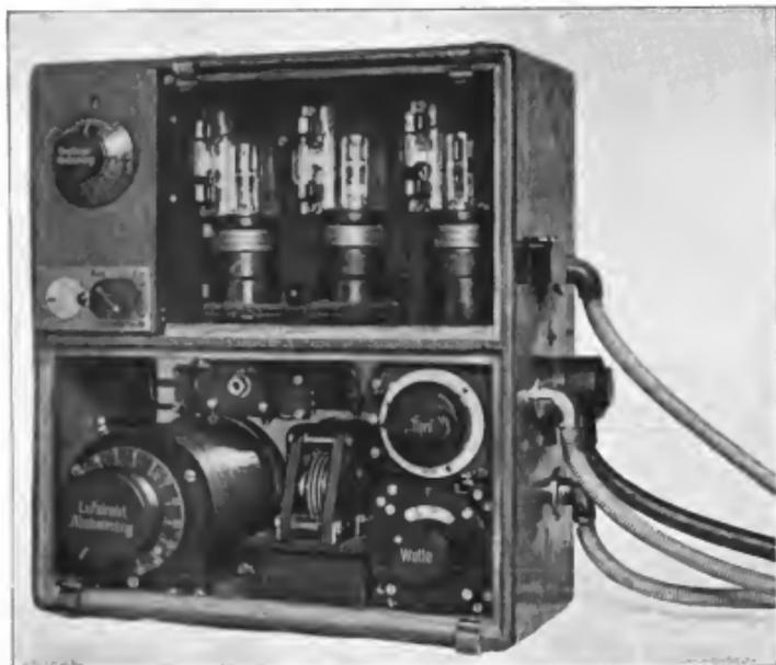
Abb. 5. Sende-Empfänger, Type N, für C-Flugzeuge, Vorderansicht mit abgenommener Deckplatte (gebaut von Telefunken).
