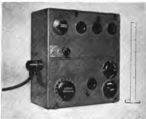
Abb. 173. Telefunken: Sender-Empfänger Type N für C-Flugzeuge mit eingebautem Röhren-Verstärker. — Vorderansicht.
