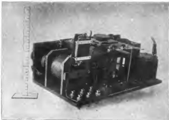
Abb. 216. Telefunken: Ungedämpfter Versuchs-Sender, Type „Beetz“.
