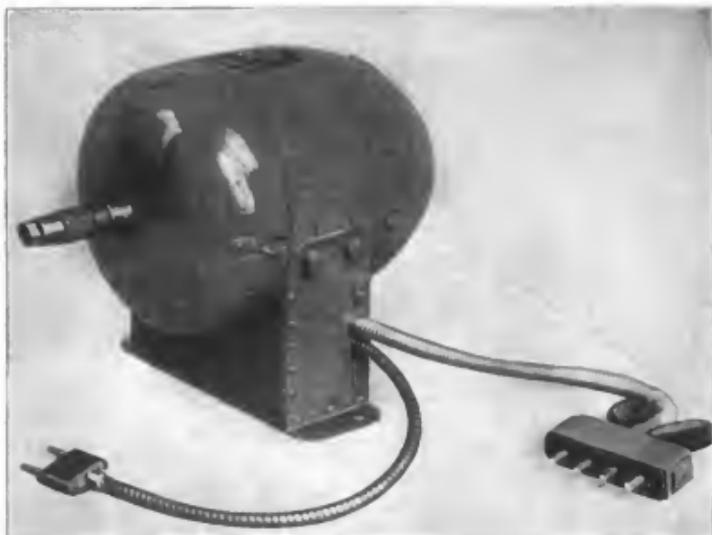
Abb. 149. Firma Dr. E. F. Huth; Einheitsmaschine L. M. G. 12 für D- und C-Flugzeuge.
