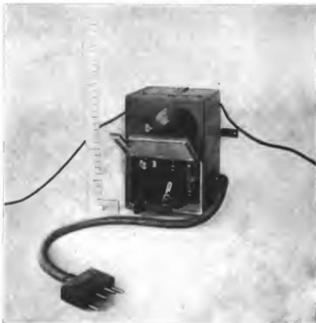
Abb. 178. Telefunken: Primär-Empfänger Type E für Kampfeinsitzer, geöffnet.
