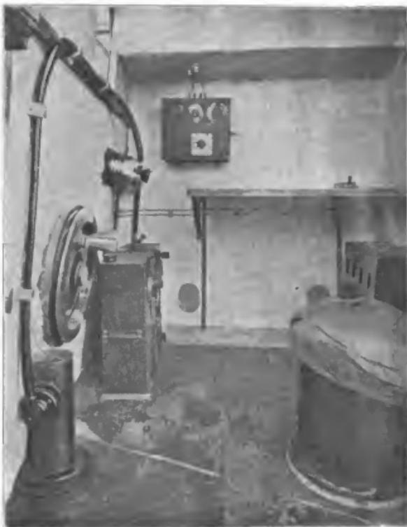
Abb. 8. F.T.-Kabine im Riesenflugzeug mit Sender-Empfänger älterer Ausführung.
