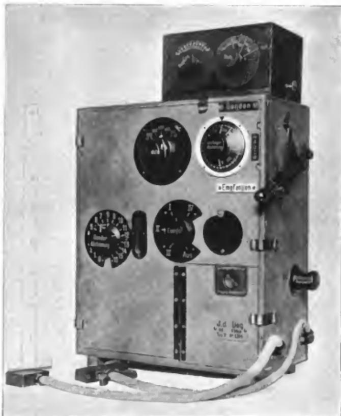
Abb. 166. Inspektion der Fliegertruppen: Sende-Empfänger Type D mit aufgesetztem Zusatzgerät für Empfang der Wellen 500—900 m.
