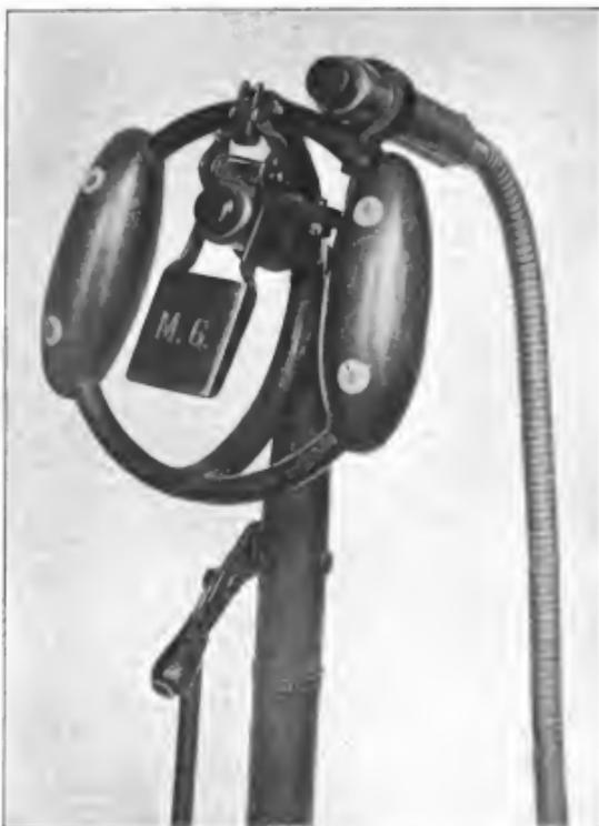
Abb. 4. F.-T.-Taste (Zwischenhöreinrichtung) am Steuerknüppel von Einsitzern (Bauart Telefunken). F.-T.-Taste mit Zuführung sitzt rechts oben, in der Mitte der Druckknopf für Motorkurzschluß und M.-G.-Hebel.
