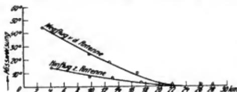
Abb. 268. Abhängigkeit der Mißweisung von der Entfernung.
