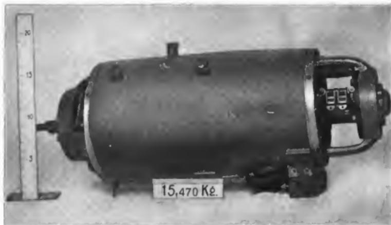
Abb. 150. Telefunken: Generator Type G für Großflugzeuge mit abgenommenen Hauben.
