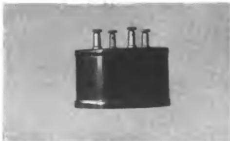
Abb. 119. Mechanisches „Einfach-Relais“ von Dr. Stille.
