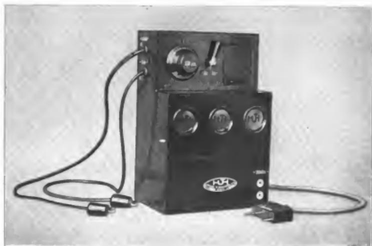
Abb. 182. Firma Dr. E. F. Huth: Empfänger Type E. für Kampfsitzer mit Kristalldetektor und Lautverstärker.
