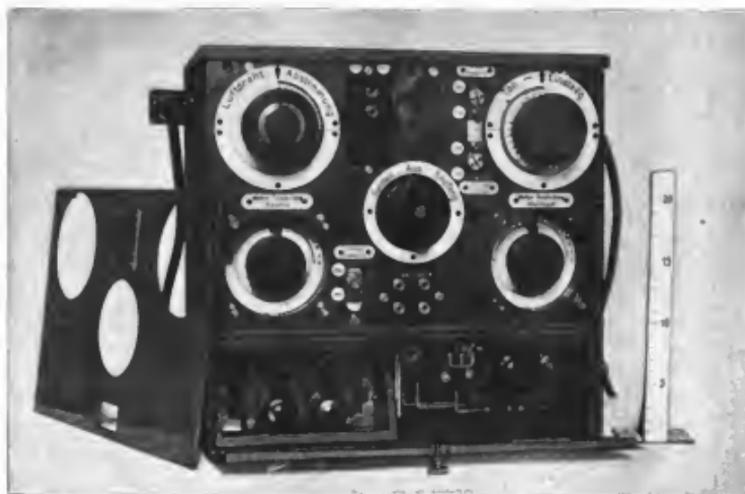
Abb. 230. Telefunken: Ungedämpfter Sender-Empfänger, Type USE I, mit abgenommener Deckplatte.
