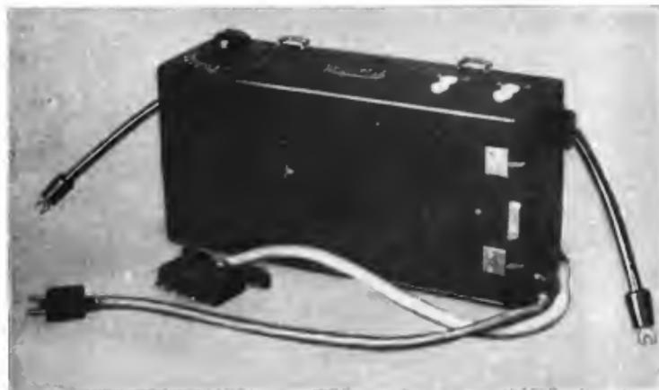
Abb. 193. Firma Dr. E. F. Huth; Empfänger-Sender Type A mit Gegensprecheinrichtung.
