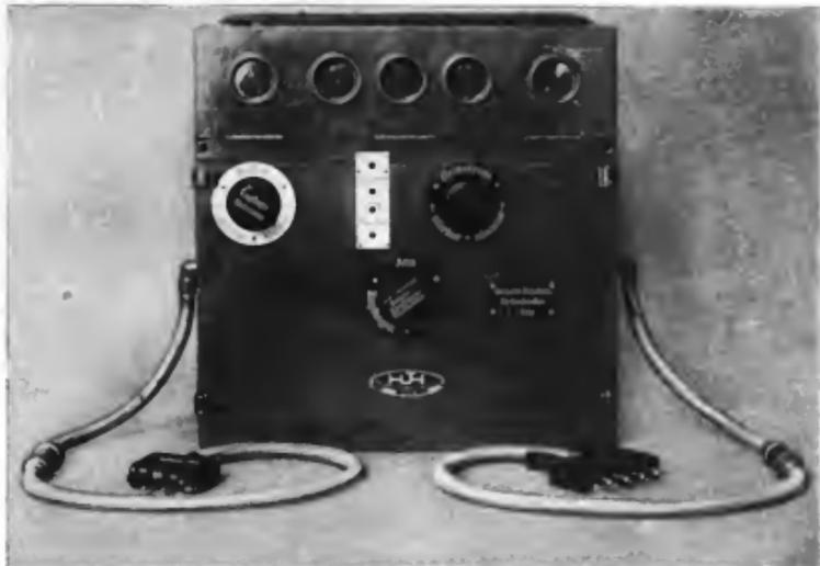
Abb. 227. Firma Dr. E. F. Huth: Type „Rude IV“ für Einstellung einer Welle für Sender und Empfänger im Bereich von 400—600 m mit eingebautem Audion-3fach-Verstärker und Senderöhre, geschlossen.
