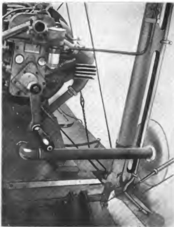
Abb. 145. Bosch-Aggregat mit angebautem F.T.-Dynamo im Riesenflugzeug.
