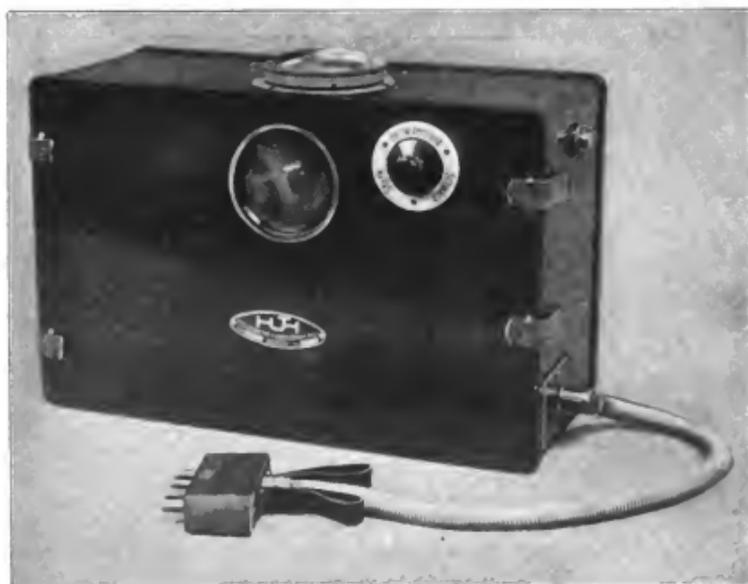
Abb. 219. Firma Dr. E. F. Huth: Erster ungedämpfter Sender mit Zwischenbüreinrichtung für eine Welle im Gebiet von 300—700 m für  $10/15$  Watt Leistung. Type „Rues“.
