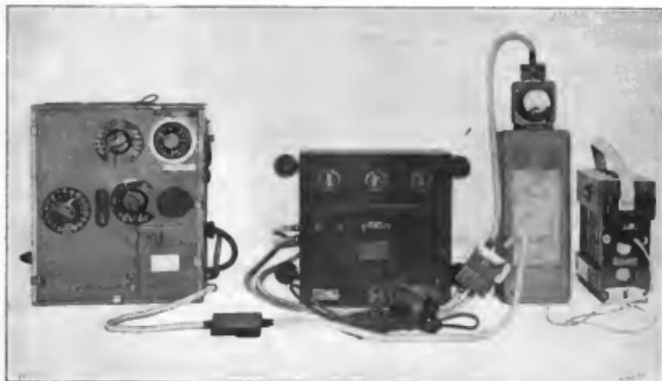
Abb. 72. Sender-Empfänger, Type D, mit Dreiröhrenverstärker Telefunken und zugehöriger 90-Volt-Anoden und 6-Volt-Heizungsbatterie.
