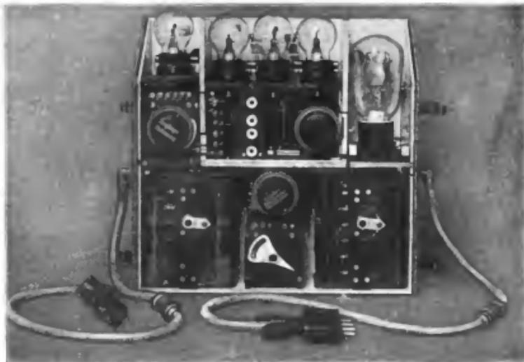
Abb. 228. Firma Dr. E. F. Huth: Ungedämpfter Sende-Empfänger, Type „Rude IV“.
