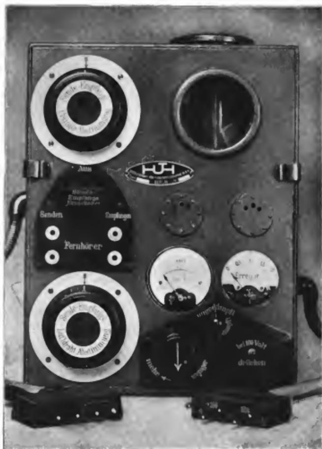
Abb. 225. Firma Dr. E. F. Huth: Type „Rude II“, Ungedämpfter Sender-Empfänger, geschlossen, für ungedämpften und gedämpften Empfang mit eingebauten 3-Röhrenverstärker für Send- und Empfangswelle von 150—600 m wie Type „Rude I“, jedoch muß mit derselben Welle gesandt werden, mit der empfangen wird.
