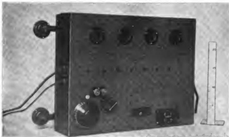
Abb. 186. Telefunken: Empfänger Type E. mit organisch eingebautem Verstärker für Kampfeinsitzer.
