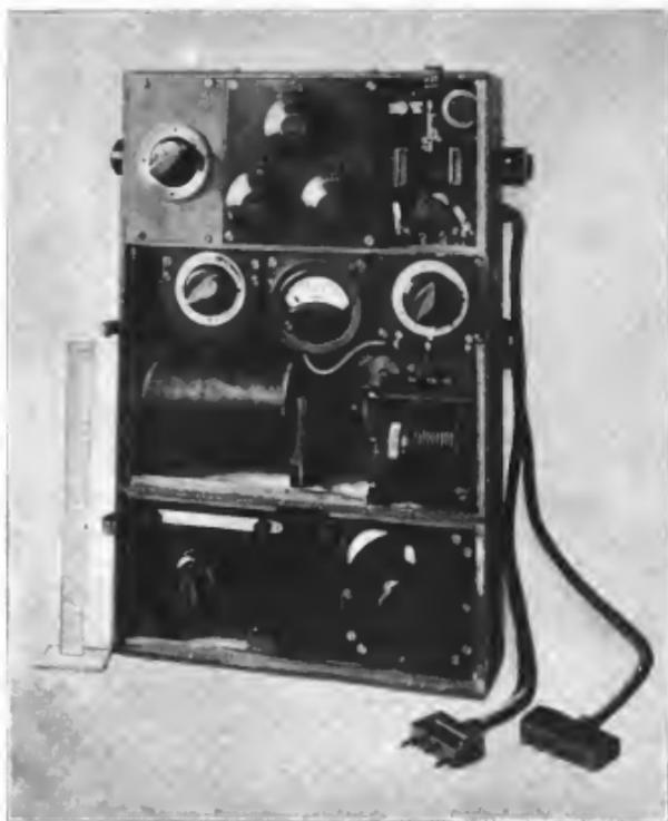
Abb. 202. Telefunken; Sender-Empfänger Type G, geöffnet. Vorderansicht.
