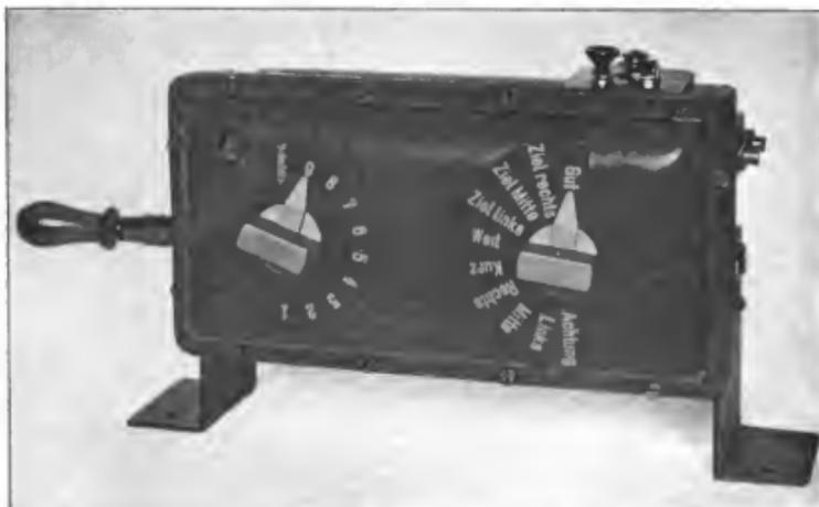
Abb. 1b. Automatischer Zeichengeber für Artillerieflyger (Bauart Telefunken).
