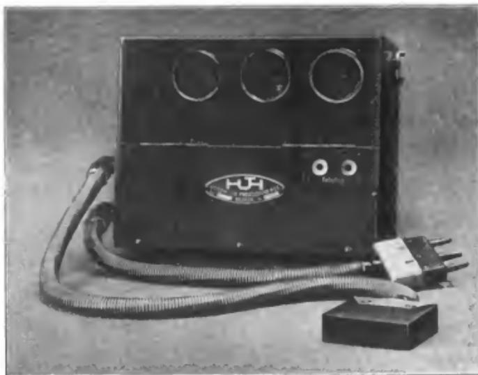
Abb. 72 a. Dreiröhrenverstärker (25-Volt-Anodenspannung) Type L 43 F 25 der Firma Dr. E. F. Huth, G. m. b. H.
