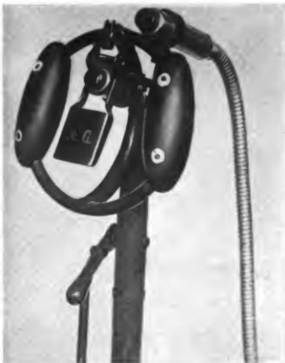
Abb. 200. Steuerknüppel mit fest eingebauter F.-T.-Taste (oben rechts).
