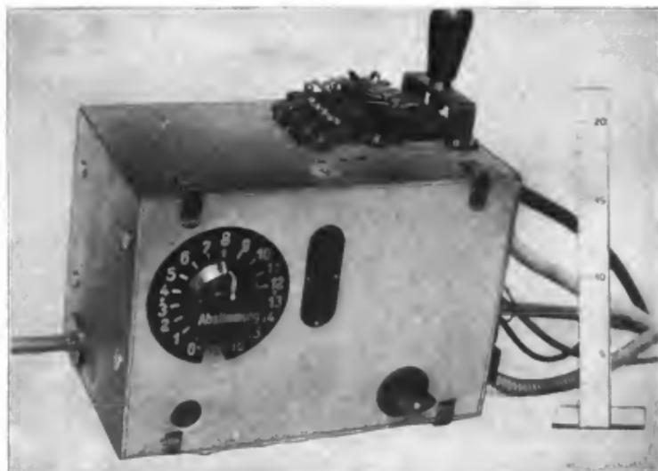
Abb. 197. Telefunken; Sender-Empfänger Type A mit Zwischenhöreinrichtung u. organ. eingebauter Taste.
