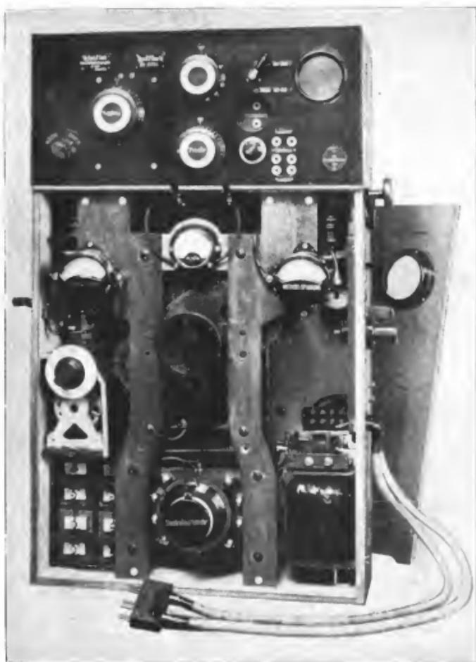
Abb. 214. Firma Dr. E. F. Huth: R-Flugzeugsender-Empfänger mit Audion und 3 Röhrenverstärker.
