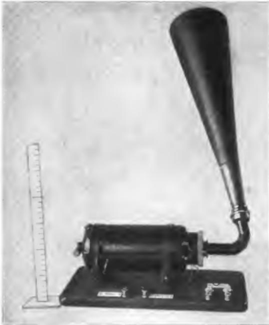
Abb. 127. Telegraphie-Ges. m. b. H. System Stille: Elektropneumatisches Relais.
